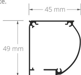
Querschnitt der Führungsschiene.
