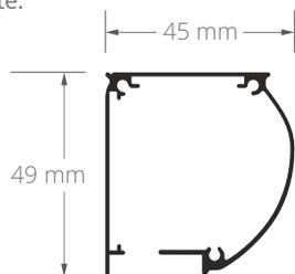
Querschnitt der Führungsschiene.
