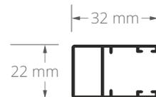
Querschnitt der Führungsschiene
